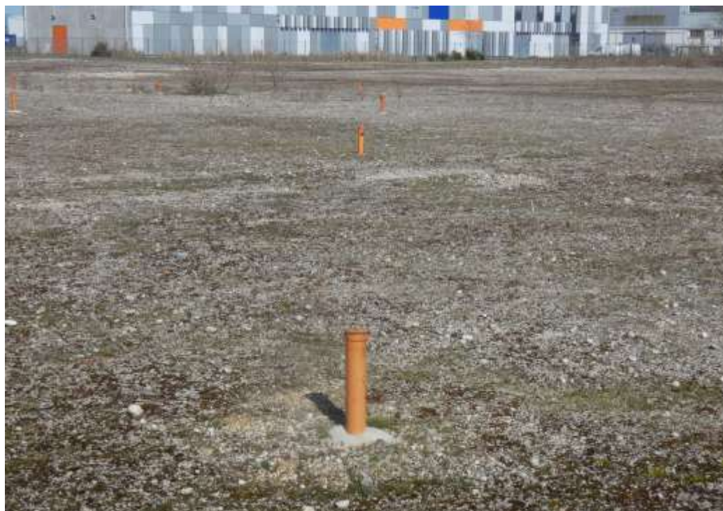
Cliché 10. Vue rapprochée du remblai avec l'alignements des « piézomètres » servant à mesurer le niveau de la nappe phréatique et la composition chimique des eaux.
